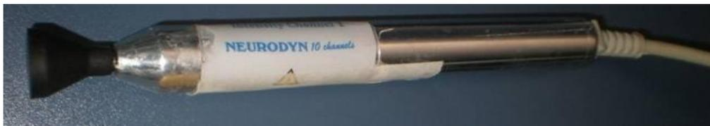
**Figura 2:** Eletrodo Caneta (Móvel). Fonte: Própria autora, 2015
