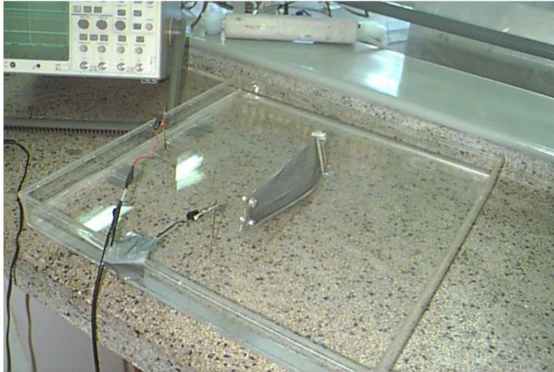
Fig.19.Cuba com água contendo o peixe dentro da rede, com 2 eletrôdos e osciloscópio para medida da d.d.p ao redor do animal.
